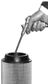
Рис. 10.3 Очистка фильтрующего элемента воздушного фильтра
